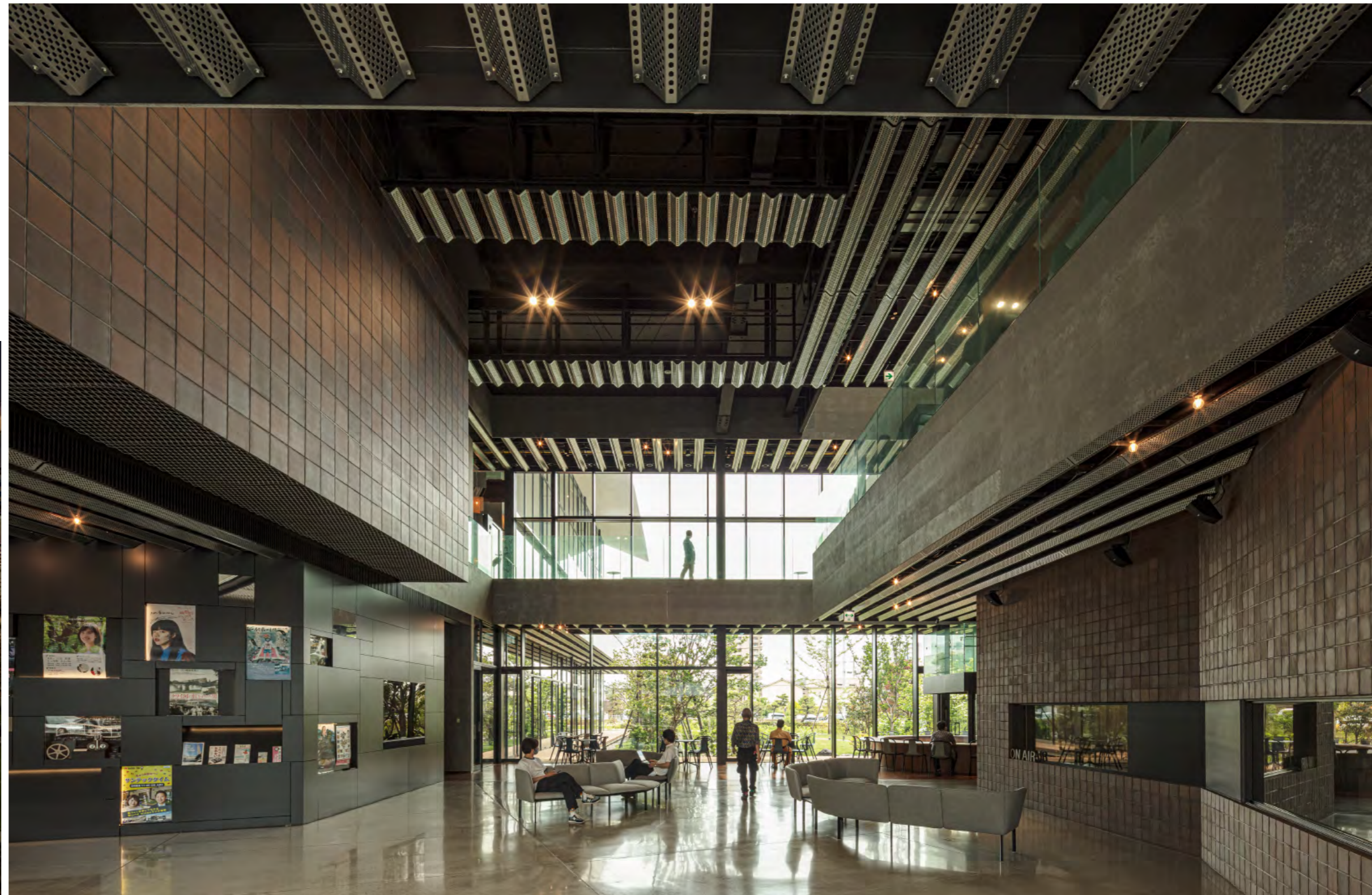
新社屋の中心に位置するエントランスホール空間は、2層吹抜けでダイレクトに庭へと視線が抜ける開放的な空間とするとともに床面や天井面に庭の緑を映し込むことで庭を内部空間に呼び込んでいる。床は研ぎ出しコンクリート、壁は地元観音寺の瓦土を練り込んだ陶器質タイル。
